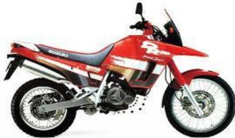
Le DR 750S, d'une cylindrée de 727 cm<sup>3</sup>, dispose d'un moteur 4 temps à refroidissement par air, celui-ci bénéficiant du [Suzuki Advanced Cooling System](#) qui sera mis de côté lorsque les avancées technologiques ne le requièrent plus, de la même façon que pour les [GSX-R](#).
