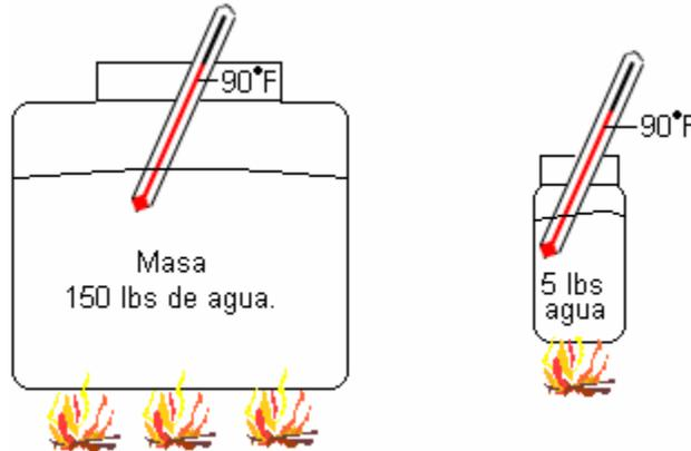
Dos sustancias con diferentes masas, pueden alcanzar y permanecer a la misma temperatura termométrica, pero la cantidad de calor que tendrán que absorber para alcanzarla será diferente en cada una tomando en cuenta, el peso y el calor específico de la materia.
