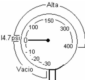
En los instrumentos diseñados para medir presiones confinadas (manómetros), se marca la presión atmosférica (14.7psi) como el punto de referencia 0.
