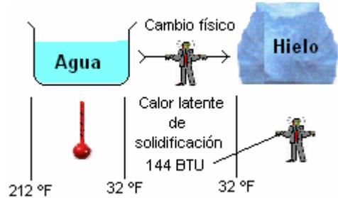
Una vez el vapor se ha convertido completamente en líquido, el termómetro nuevamente registra un cambio en la temperatura hasta alcanzar los 32 °F. En este punto, comienza un cambio físico de líquido a sólido.
