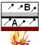
Cuando dos cuerpos a diferentes temperaturas se ponen en contacto, el más caliente (A) comunica energía al menos caliente (B) el tipo de energía que se traspasa de un cuerpo a otro como consecuencia de una diferencia de temperaturas es precisamente, la energía térmica.
