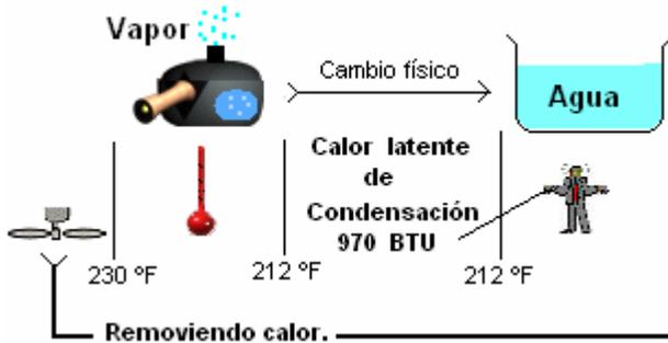
A partir de los 230 °F se registra un cambio de temperatura en el termómetro hasta los 212 °F. Después de este punto el termómetro no registra cambios en la temperatura, pero el vapor comienza a convertirse en líquido. En este proceso de cambio, interviene el calor latente de condensación. (970 BTU)
