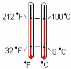
Puede notar que los puntos fijos de los dos termómetros, tanto los de ebullición del agua como los de fusión del hielo, coinciden en ambos instrumentos.
