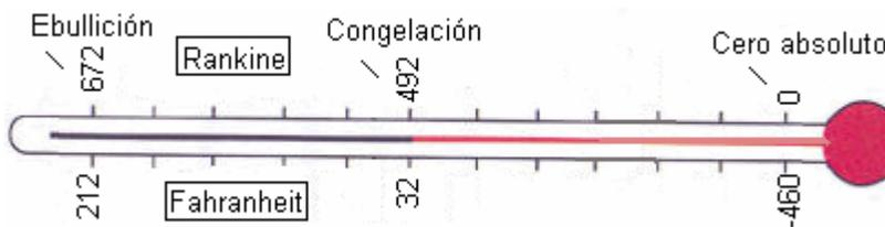
En la escala Rankine, el punto de congelación del agua equivale a 492 °R, y su punto de ebullición a 672 °R.
