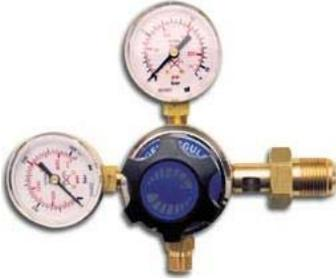
La presión normal en el cilindro de oxígeno es de 2,400 lb/pulg<sup>2</sup>. Esto significa que el manómetro más cercano al tanque debe indicar hasta 2,400 lb, cuando menos. El segundo manómetro, que indica la presión en la salida del regulador, indicará la presión de trabajo del oxígeno en la manguera y en el soplete. Algunos procesos oxiacetilénicos requieren una presión de trabajo más alta en el oxígeno.
