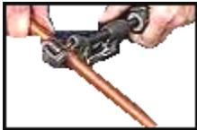
Usando un cortador de tubos, corte todos los tramos de acuerdo al diseño, limpie las dos superficies a ensamblar (exterior del tubo e interior) con lija #120, o con un cepillo de alambre.
