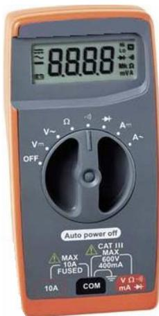
Los Multímetros (todos) tienen un medio de protección por fusible, instalado usualmente para proteger la escala de continuidad.
