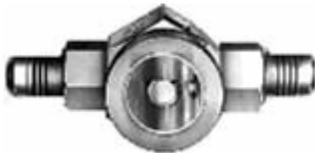
**Mirilla** (Sight glass): Permite observar el flujo de refrigerante en el sistema. La burbuja o espuma es una advertencia de poco refrigerante en el sistema. (Se instala en la línea de líquido)
