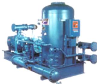
El compresor de tornillo sencillo es una máquina rotativa de desplazamiento positivo con inyección de aceite que puede ser operada con los refrigerantes industriales más comúnmente utilizados. Este consiste de un tornillo helicoidal central, el cual está flangeado por un par de rotores del tipo estrella. Los rotores se acoplan a la forma del tornillo para
