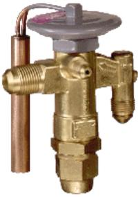
**Válvula de expansión termostática:** Por su eficiencia y adaptabilidad a cualquier tipo de aplicación, éste es el control más usado en las neveras comerciales. Su funcionamiento se basa en el ajuste adecuado del grado de sobrecalentamiento en la salida del evaporador, condición que permite mantener el evaporador lleno de refrigerante bajo cualquier cambio surgido en la carga de calor. (En estas neveras constantemente se saca mercancía fría y se coloca más mercancía caliente.)
